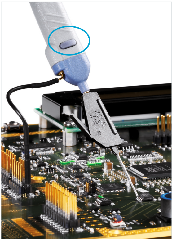
Практичная конструкция: микрокнопка обеспечивает удобное управление прибором. Разнообразные наконечники пробников и кабели заземления включены в стандартный комплект принадлежностей.
